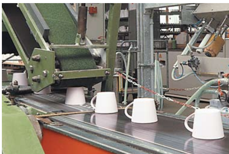
Abputzen der Tassenfüße Fettling of cup feet
