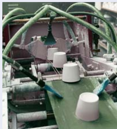
Begießglasieren von Tassen Waterfall glazing of cups
